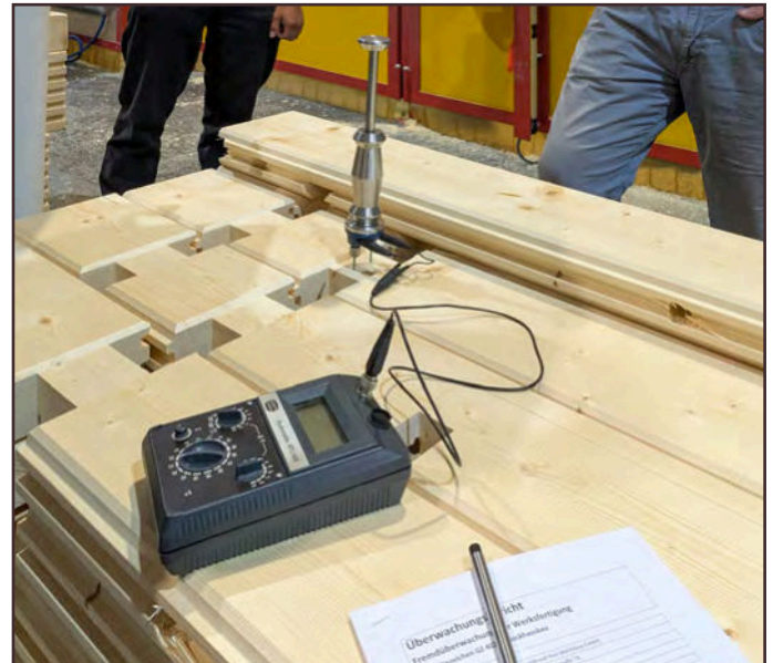
Jede Messung der Holzfeuchte wird akribisch protokolliert und ausgewertet. Ein Wert zwischen 12 und 15% ist optimal.
