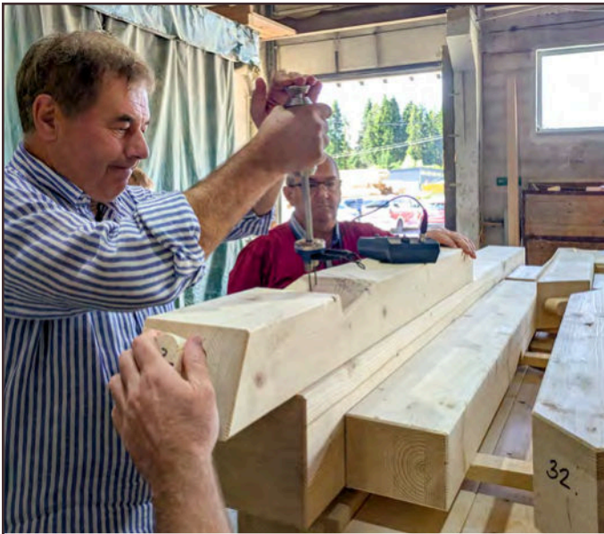
Das Holzfeuchte-Messgerät ist bei jeder RAL-Prüfung ein wichtiges Instrument. Josef Egle (l.) prüft damit die einzelnen Bohlen.
