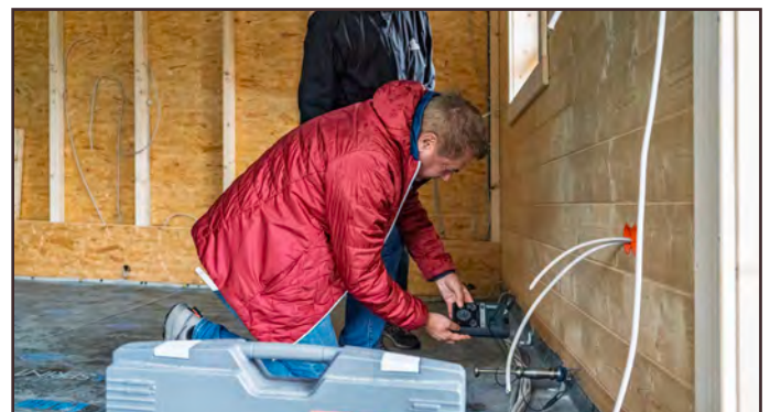
Auch beim fertiggebauten Blockhaus ist die Holzfeuchtemessung eine zentrale Methode, um die Qualität der Montage zu prüfen.
